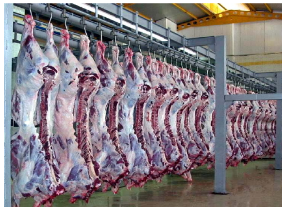
Acél tartók, konzolok, conveyor-szállító, továbbító szerkezetek, elláthatók antibakteriális és penészedésgátló bevonattal.
